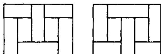
图1-6 三相铁心的叠装次序
